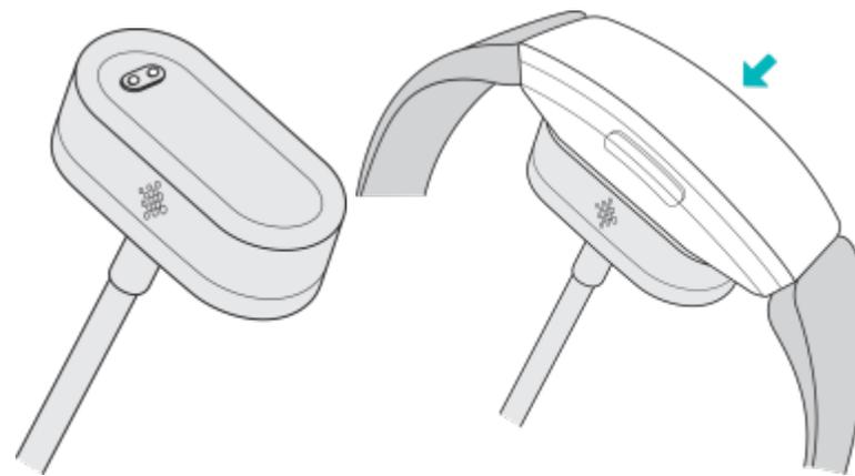
La ricarica completa richiede 1-2 ore. Durante la ricarica del tracker, puoi premere il pulsante per controllare il livello della batteria. Un tracker completamente carico mostra un'icona di batteria piena con uno smile.
