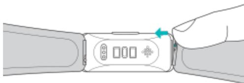
3. Quando entrambe le estremità del perno sono inserite, rilascia il fermo a rilascio rapido.
